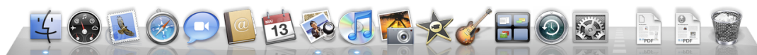
Figure 1: Le Dock, contenant à gauche les icônes d'applications (un halo bleu indique que l'application est lancée, ici Finder, Aperçu et iTunes), et à droite fichiers, dossiers et corbeille.
